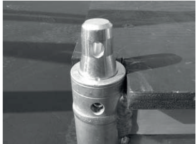
(Konusverbinder in Konusbuchse der Treppenstufe)
