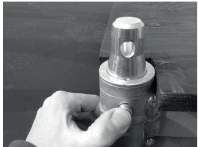
(Konischer Bolzen von Hand eingedrückt)
